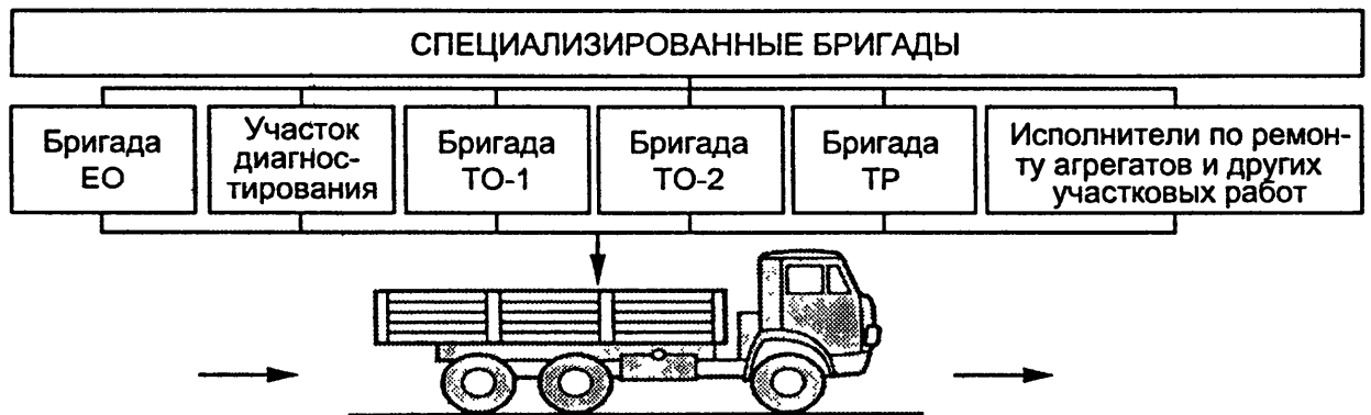
Рис. 5.1. Схема обслуживания подвижного состава методом специализированных бригад
