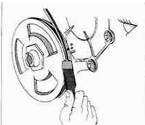
Рисунок 1 – Совмещение меток на шкиве КВ и блоке
