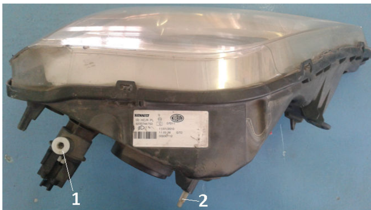
Рисунок 7 – Места регулировки фар Рено Логан: 1 – горизонтально, 2 – вертикально
